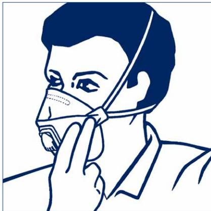
4. Posizionare l'elastico inferiore sotto le orecchie e quello superiore sopra le orecchie. Aggiustare i lembi superiore ed inferiore fino ad ottenere la tenuta ottimale.
