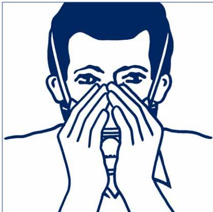
6. Per verificare la tenuta, appoggiare completamente le mani sul respiratore e inspirare rapidamente. Se si dovessero avvertire problemi di tenuta, ripetere le operazioni di indossamento.
