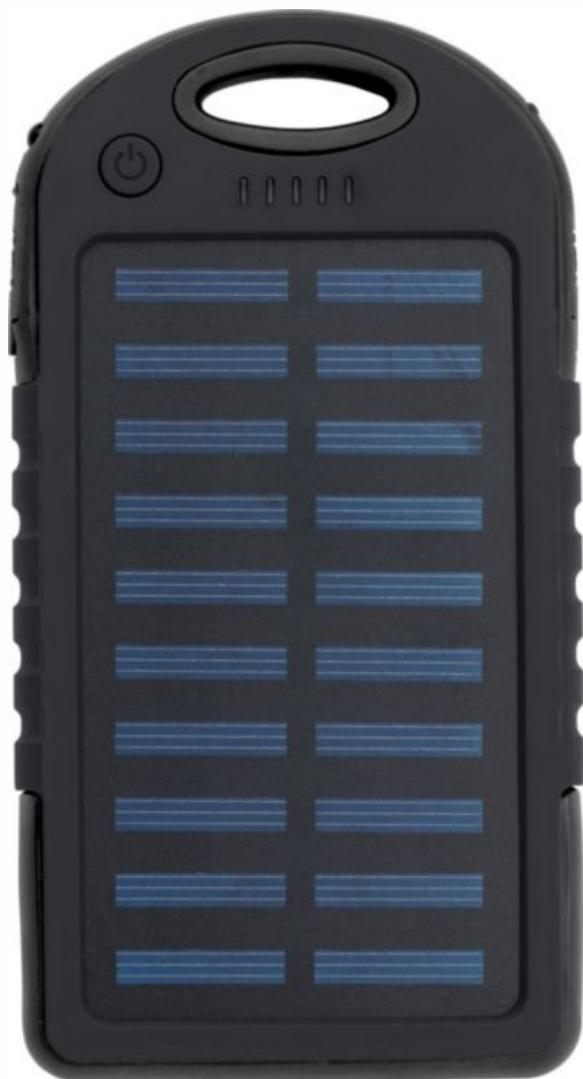
Power bank solare in ABS con rivestimento gommato, include luci LED indicatrici verdi e torcia laterale integrata, dotato di due porte USB, una porta USB-C, ricarica solare 5V/200mA, ingresso DC 5V/1A e uscita DC 5V/2x1A, capacità di 4.000 mAh, cavo USB incluso.
